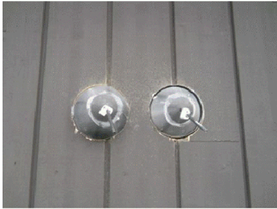
Figur 22 Uteluft, avluft och avlopp tätades med ballong
